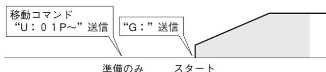
GP-IB回線のGetコマンドにより、多軸の同時スタートを実行するには、Getコマンドを送る前に、“U : 01”アブソリュート移動コマンドで、移動先を設定しておきます。
