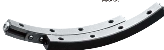
傾斜用のV-B方式ガイドレール。 鋼球が接触する4点の上2点の 軌道距離は狭く、下2点の軌道 距離は広い。 この軌道距離の差は製品ごとに 異なる。
