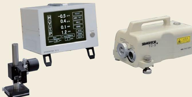
直線運動の4つの誤差成分(水平・垂直・ヨーイング・ピッキング)を同時に測定できる真直度測定機です。
