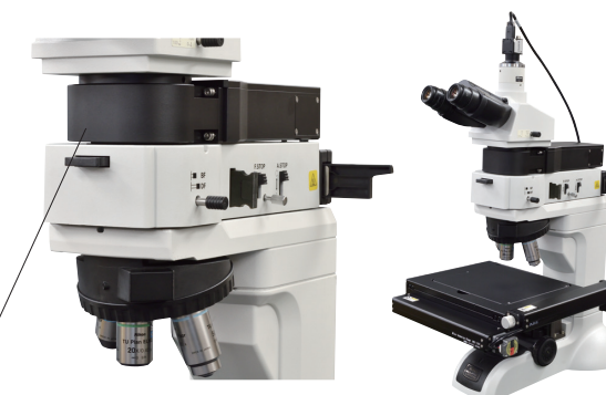
AF-L-UN：顕微鏡との組み合わせが可能なAFユニット
