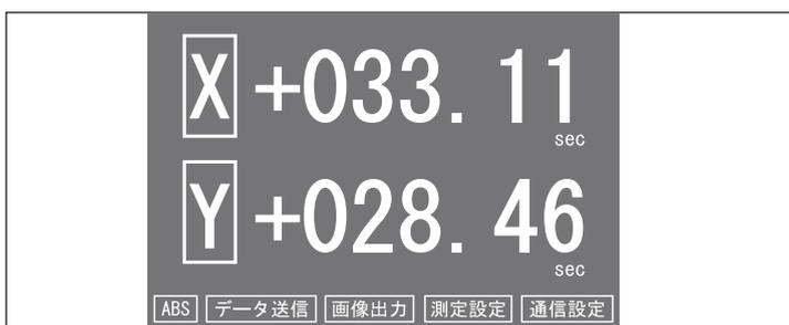
5 測定値が、X、Y 軸とも 0" に近くなるように、さらに反射鏡や LAC-SA 本体の位置を微調整します。
