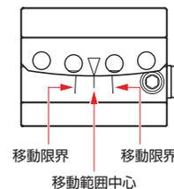
傾斜ステージは図で示した「移動範囲内」でお使いください。「移動範囲」を超えて送りねじを回すと破損する恐れがあります。送りねじを回すときは「指標」を確認しながら行ってください。(図は TS-2551FX です。)
