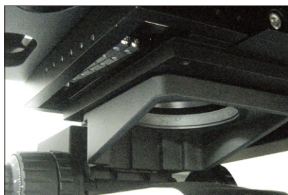
AF駆動部(薄型) AF-261ZA装着の状況
