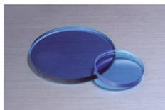
人の眼に感じることのできる可視スペクトル(400-700nm)に対して、ある帯域を吸収し、それ以外の帯域を透過する機能を有します。基板自体による光の吸収によって所定の光学特性を実現するため、基板の板厚を制御することで正確なフィルタリングが可能となります。カラーフィルタをロングパスやショートパスフィルタとして用いることもあります。なおコーティングタイプのダイクロイックフィルタと比べた場合、透過帯から透過阻止帯への移行はそれほど急峻ではありません。しかしながら、カラーフィルタのピーク透過率は、ダイクロイックフィルタのそれよりも高い傾向があります。また得られる光学特性に入射角依存性はありません。当社では標準品としての取り扱いはなく、特注品として対応しています。
