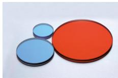
バンドパスフィルタは、ある特定波長帯のみを透過する機能があります。極端に狭い帯域(2nm以下から10nm程度)のみ透過する狭帯域フィルタと、ある程度広い帯域(50-80nm程度)を透過する広帯域フィルタに大別されます。光学特性の入射角依存性が特に高く、光学系に組み込む際にはその設置場所に特に注意を要します。バンドパスフィルタには、ソフトコーティングを採用したものがあります。このタイプのフィルタを選定すると、選択波長における透過率を最大化することができます。当社では標準品としての取り扱いはなく、特注品として対応しています。
