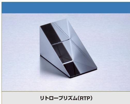
30°、60°、90°の角度構成を持ったプリズムです。B-C面へのアルミコートの有無により、分散プリズムや偏角プリズムとして機能します。
