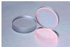
透過を遮断する波長帯と、透過波長帯であるパスバンド帯を併せ持つフィルタです。ロングパスフィルタは、特定のカットオン波長よりも長い全ての波長をパスします。コールドミラーやフィルターガラスなどもロングパスフィルタの仲間に分類されます。
