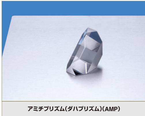
直角プリズムと同じ角度構成(90°、45°、45°)ですが、斜面(反射面)は直角二面鏡の屋根型形状(ダハ面)になっています。この面により、垂直入射時に倒立像の状態で90°に偏角します。レンズ光学系により反転した像状態を正立像に変換するのに最適です。一眼レフカメラや顕微鏡等の光学系に広く利用されます。
