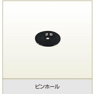
スペシャルフィルタはレンズとピンホールで構成され、レンズの集光位置にピンホールを配置することでゴミやレンズのキズなどにより発生する干渉縞を取り除き、ノイズのない綺麗に整形された拡散光を作るために使用されます。
